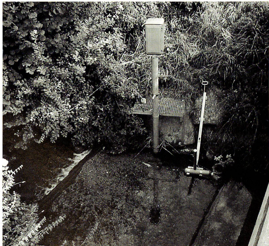
Abb. 8: Abflussmessstation im Rotbach bei Sempach mit Schwimmer und automatischem Pegelschreiber (links) und Probenehmer bei Hochwasser (rechts).
