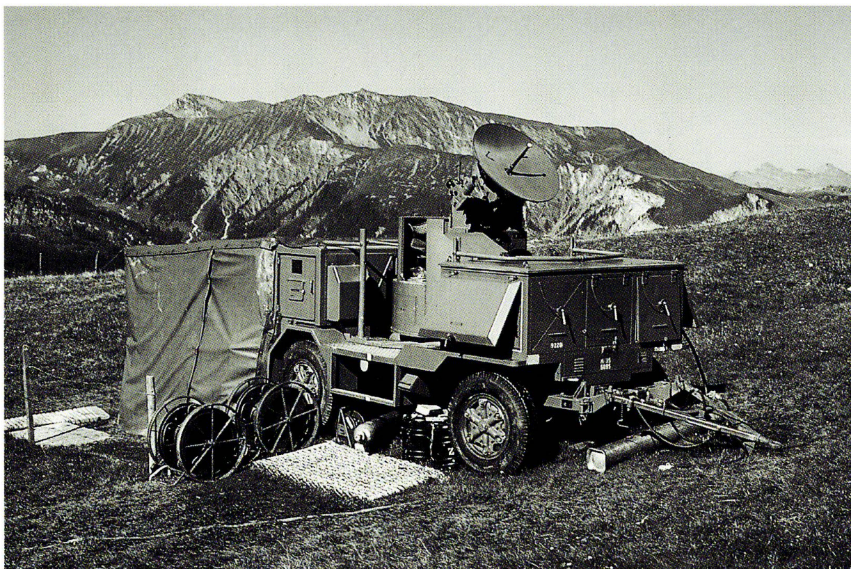
Abb. 3: In der Vogelzugbeobachtung setzt die Vogelwarte auch Radargeräte ein, wie diese «Superfledermaus», die von der Armee zur Verfügung gestellt wurde.
