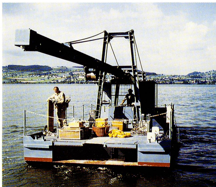
Abb. 4: Der Gesundheitszustand des Sees wird von der EAWAG permanent überwacht. Das Arbeitsfloss dient zur Einrichtung der Belüftungsanlagen sowie zur Entnahme von Proben für die Laboruntersuchungen.
