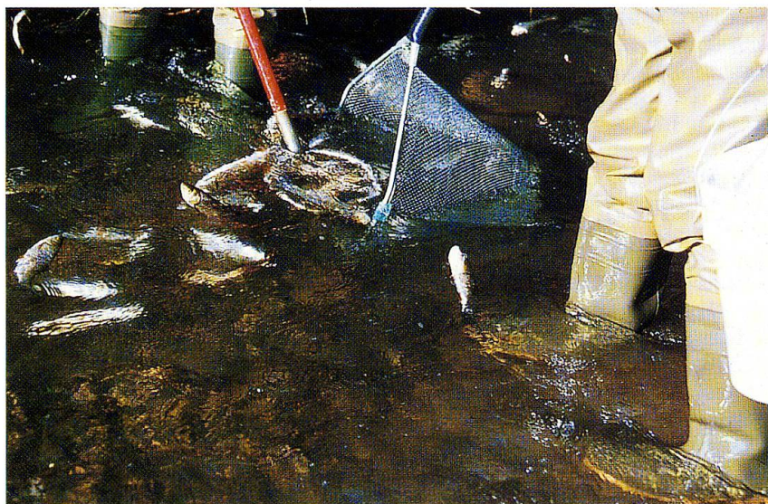
Abb. 1: Elektrofischerei: Mit dem Eintauchen der Anode schliesst sich der Stromkreis und die narkotisierten Fische können mit einem Netz eingesammelt werden. Nach kurzer Zeit erholen sie sich wieder und werden ohne irgendwelche Schädigungen in die Freiheit entlassen.
