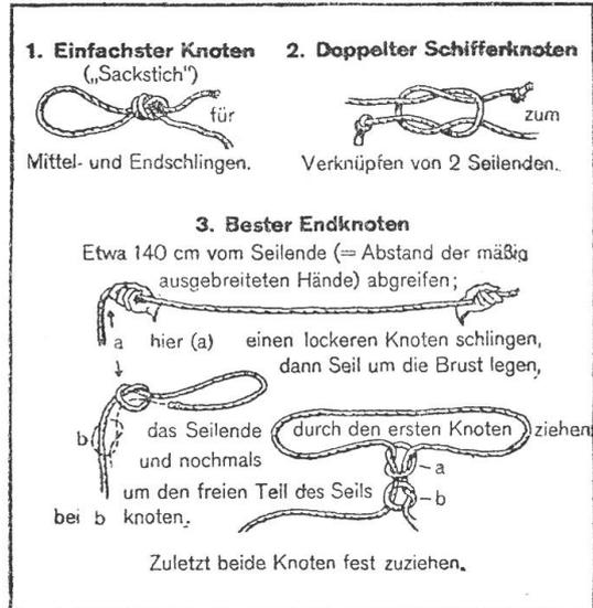
**Bild 5.** Das Knüpfen eines Knotens. Vor Gebrauch stets durch Anziehen nach allen Seiten prüfen! Bei 2 u. 3 empfiehlt es sich, an die Seilenden einen Knoten zu machen. Es ist ratsam, diese verschiedenen Knoten gelegentlich daheim zu üben.
