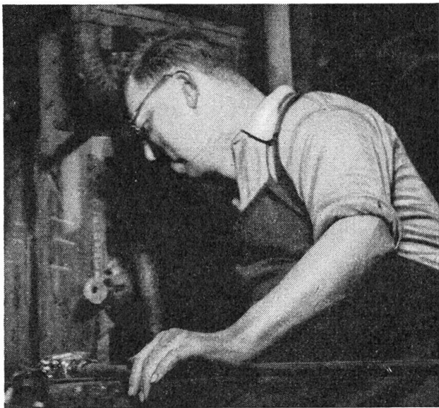
An der Wiege des Kaffeeglasses: Ein charaktervoller Glasbläser rollt die Kelchform aus, und in der nächsten Sekunde wird der Hals aufgesteckt werden
