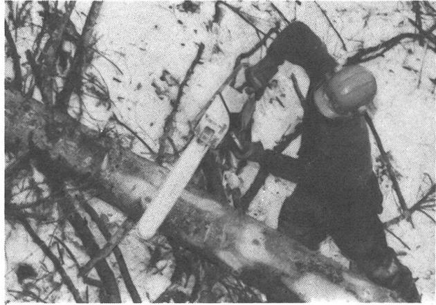
Entasten ist für den Waldarbeiter eine der zeitraubendsten Beschäftigungen. Die Axt, die Jahrhunderte hindurch für diese Tätigkeit gebraucht wurde, ist jetzt durch die Motorsäge verdrängt worden. Der Holzfäller von gestern: Axt, Hut, Brissago. Der Forstwart von heute: Motorsäge, Schutzhelm mit Schutznetz, unter dem ein Brissago kein Platz findet.
