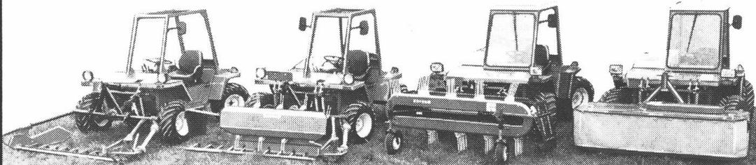
**Metrac 2002:** 27 PS mit Hecklenkung    **Metrac 2003:** 27 PS Allradlenkung, umschaltbar auf Front- oder Hundeganglenkung    **Metrac 3003 S:** 38 PS    **Metrac 3003 K:** 38 PS
