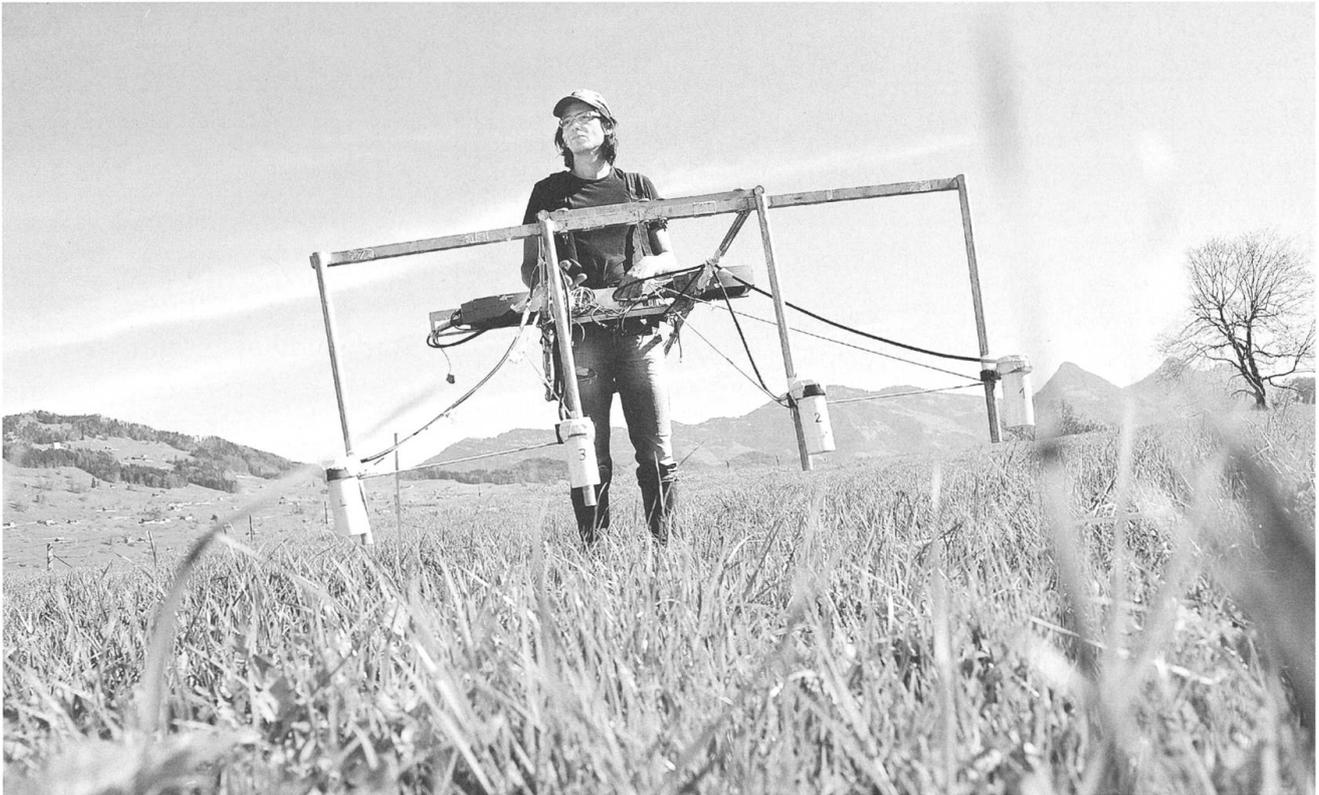
6.4. Ennerberg: Lutz Capeller läuft mit dem Magnetometer Schritt für Schritt die zu untersuchende Fläche ab.
