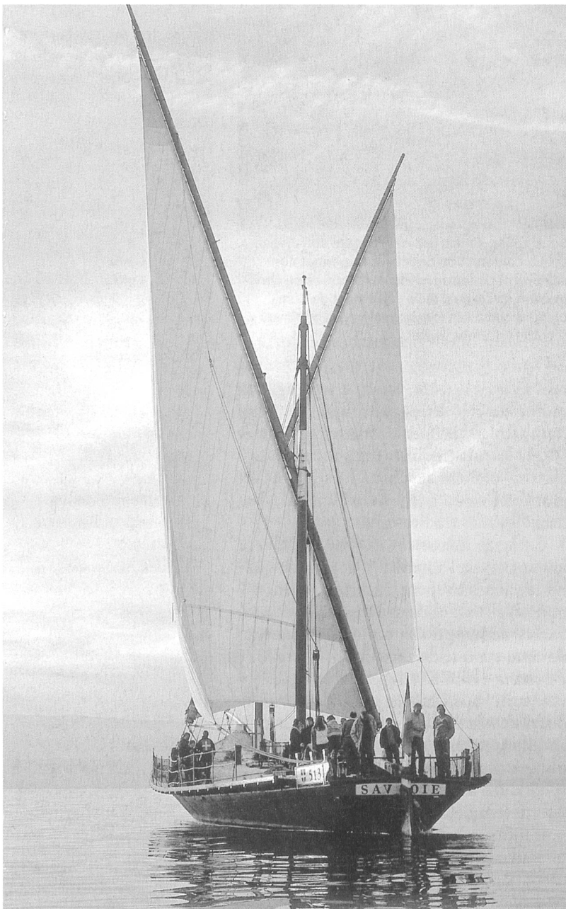
Violette , future Vaudoise , la dernière barque traditionnelle, a été lancée en 1931. Il a fallu attendre près de 70 ans pour voir à nouveau une barque construite sur le Léman. L'initiative en est revenue aux riverains français du lac, avec Savoie , réplique d'une barque homonyme du début du XX e siècle. Elle fait ici ses premiers essais, les voiles «en oreilles», une caractéristique des barques du Léman quand elles naviguent aux allures portantes (A. Genoud).
