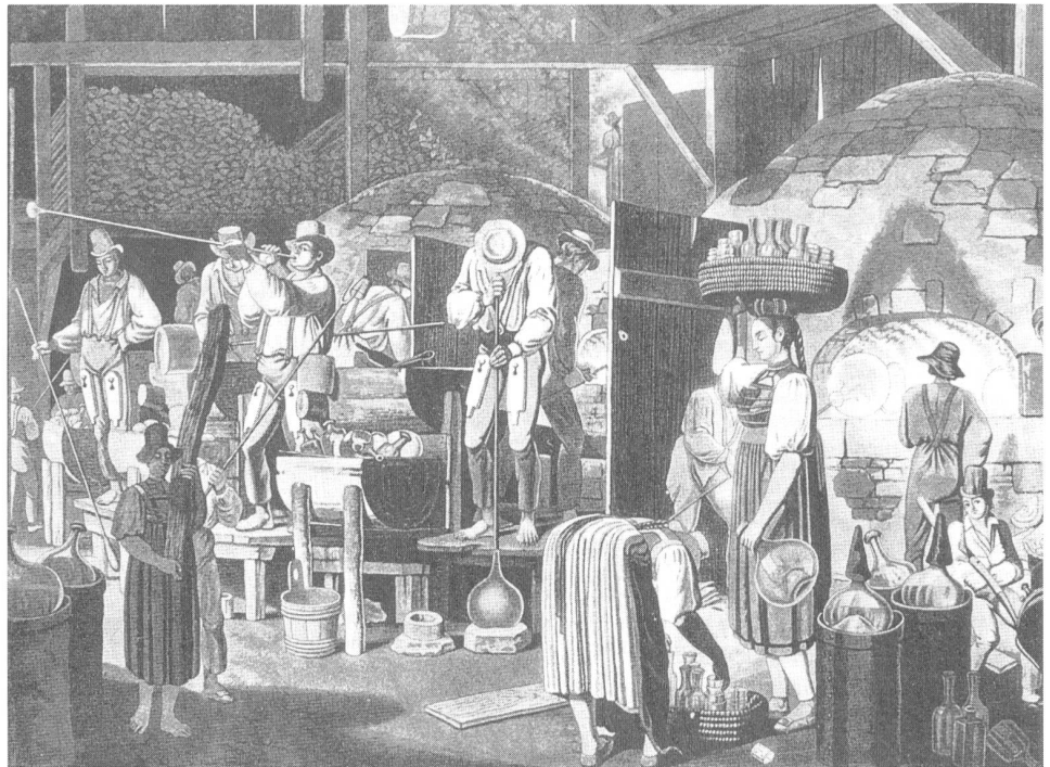
Fabrication de bouteilles et pichets à la verrerie d' Aeule en Forêt-Noire (Gravure de C. Meichelt d'après J.M. Volz, 1809).
