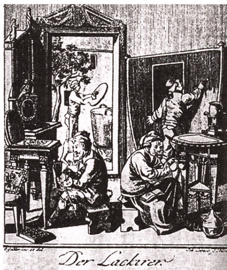
Werkstatt des Lackierers im 18. Jahrhundert, Stich von Joh. Leitner, Nürnberg 1788. Dargestellt wird im Hintergrund das Kochen des Firnisses und das Lackieren eines Kutschenkastens, im Vordergrund die Bemalung und Vergoldung lackierter Möbel.
