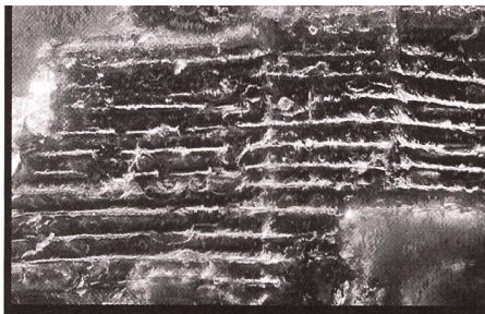
Abb 4a: Holzstruktur der Eibe, Radial-schnitt, 30-fache Vergrößerung, durchs Auflichtmikroskop aufgenommen.
