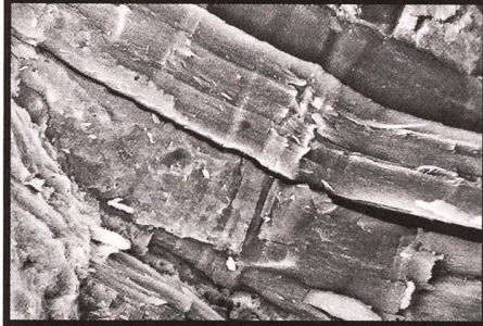
Rasterelektronenmikroskop (REM) Bilder: Abb. 4b Leinen- oder Hanffasern
