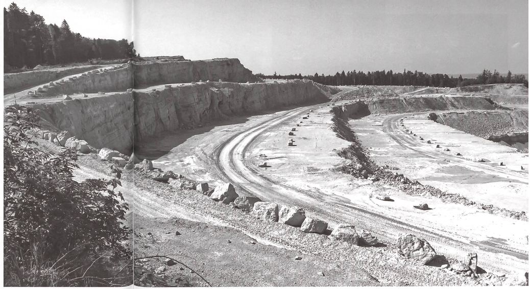
Steinbruch Gabenchopf bei Villigen (AG). Jurakalk wird hier für die Herstellung von Portlandzement abgebaut. Es ist ein aktueller, grossräumiger Abbau, der dank seiner geschützten Lage im Landschaftsbild jedoch kaum wahrgenommen wird.
