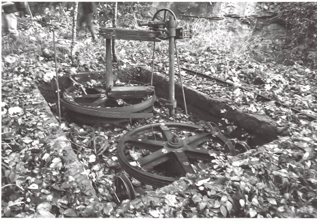
Relikte einer wohl bald 100-jährigen Förderanlage des Zuger Sandsteins, in Lutenbach (ZG).
