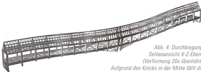
Abb. 4: Durchbiegung, Seitenansicht X-Z-Ebene (Verformung 20x überhöht). Aufgrund des Knicks in der Mitte fällt die Brücke unter einem Winkel von  $1,46^\circ$  auf die Seite.
