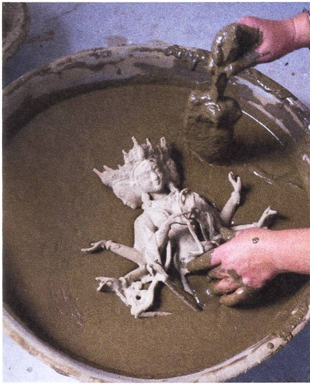
Abb. 8: Viele bei uns verloren gegangene Arbeitstechniken können in der Dritten Welt beobachtet werden, wo die Kunsthandwerker/-innen noch alle Feinheiten und Tricks beherrschen. Hier ein Beispiel aus Patan (Nepal) mit der Herstellung der Gussformen über den Bienenwachsmodellen für Buddha-Statuen: links die inneren Schichten aus fein geschlammtem Lehm, rechts die äussere Umhüllung mit Lehm und Reishäcksel.
