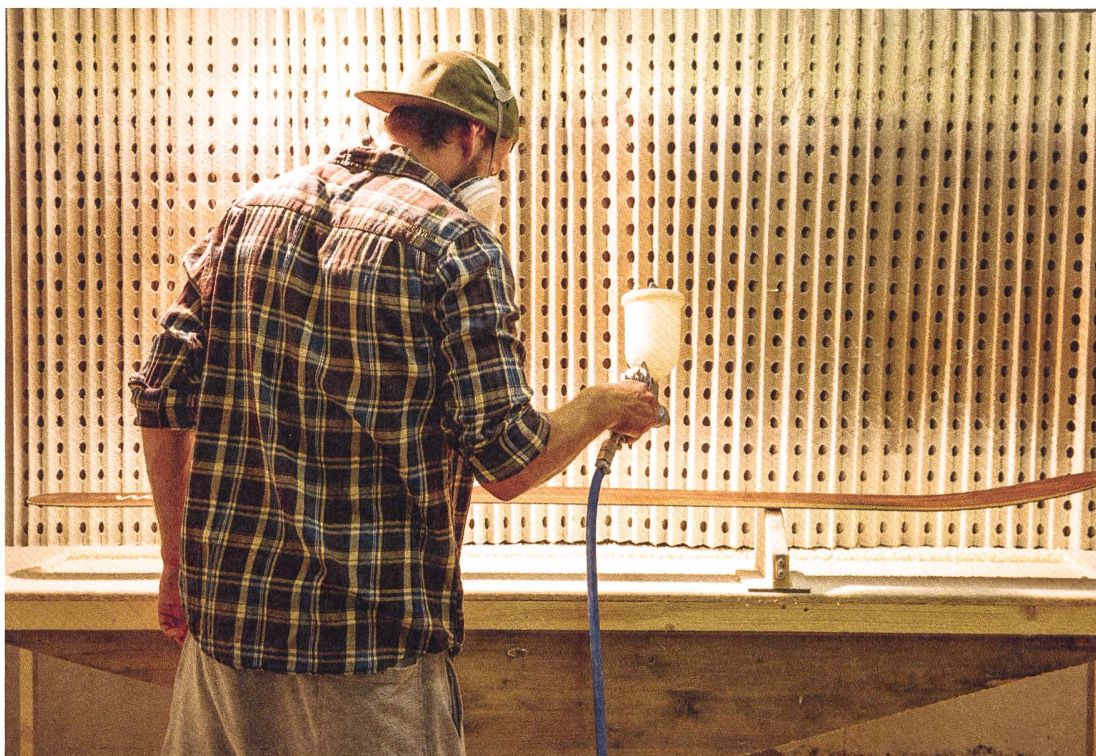
Application de la couche de finition au pistolet.
