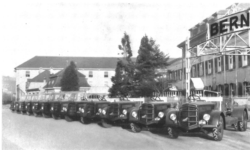
Eine Serie Armee-Chassis zur Abnahme-Kontrolle bereit
