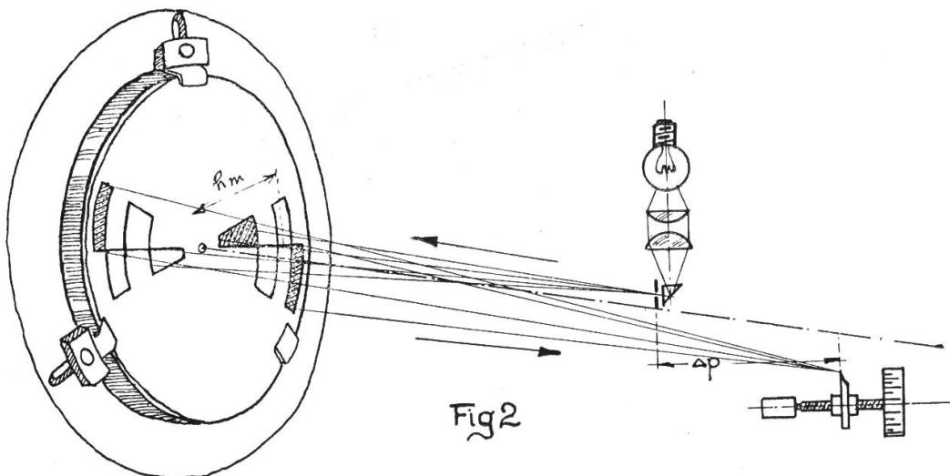
Lorsque le couteau passe dans le plan focal de 2 fenêtres de même ordre celles-ci s'éteignent simultanément. Comme par rapport à la sphère, la déformation d'un miroir parabolique croît à mesure que l'on s'éloigne du sommet, Couder propose d'utiliser un écran dont les zones soient contigües et ayant pour bords des arcs délimités par des circonférences dont les carrés soient en progression géométrique.
