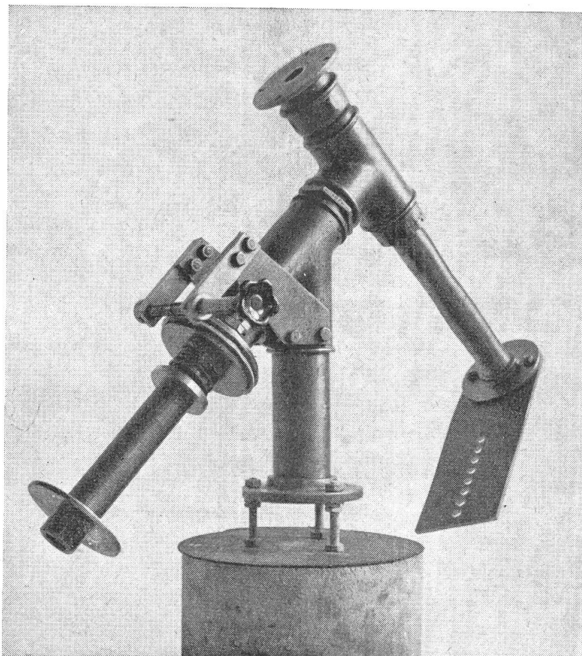
Fitting-Montierung mit Flansch für Rohr-Wiege, Fundament- schrauben (für feste Aufstellung) und Feinbewegung in Rektaszension. Am untern Ende der Deklinationsachse (rechts) Platte für Gegengewichte.
