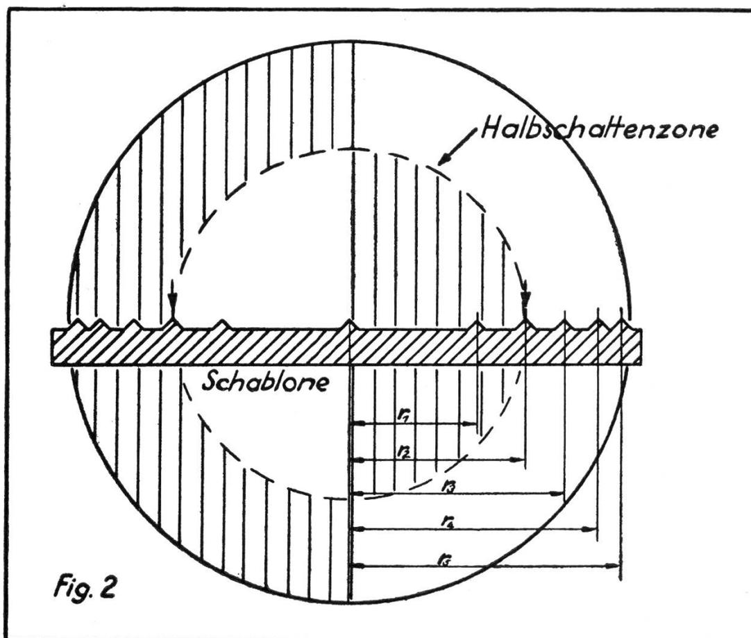
Man kann nun durch folgendes Vorgehen die Zonenprüfung, die bei grossen Differenzen bzw. Oeffnungsverhältnissen unumgänglich wird, stark vereinfachen: Bewegt man die Schneide mittels einer Schraube der bekannten Ganghöhe  $g$  in gleichmässigen Intervallen aus dem Krümmungsmittelpunkt der Spiegelmitte vom Spiegel weg, so wandern die den jeweiligen Krümmungsradiendifferenzen  $d =$
