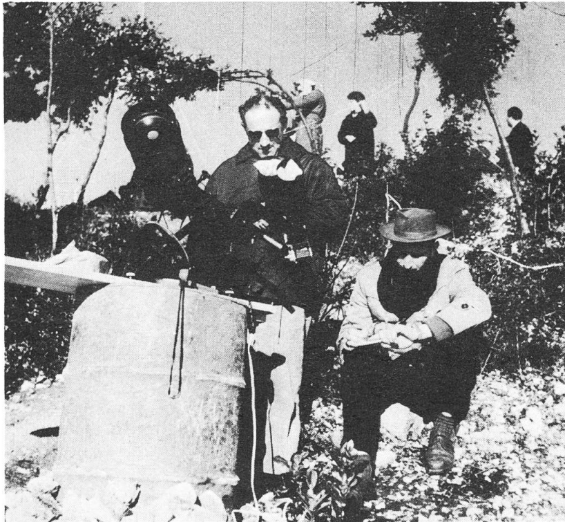
Bild 8 - Maksutow-Cassegrain Teleskop von M. Ducrey, Genf, auf Monte Cónero. Oeffnung 15 cm, Brennweite 220 cm. Spiegel ohne Versilberung. (Photo A. Kűng, Allschwil-Basel.)
