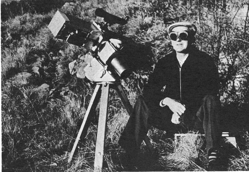
Abbildung 2 - 10 cm-Spiegelteleskop von 160 cm Brennweite, verwendet für Aufnahmen auf Monte Bignone, von W. Bohnenblust (siehe Text).
