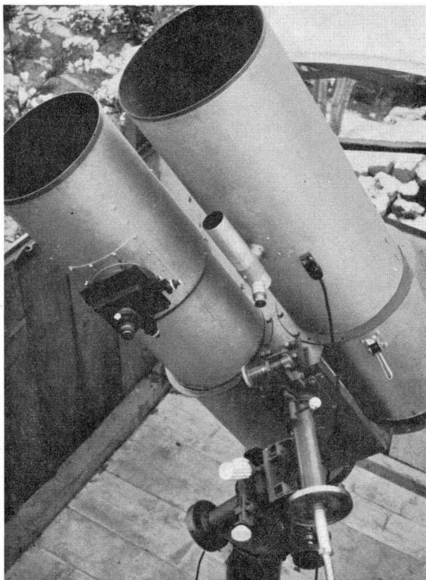
*Fernrohre von Herrn J. LIENHARD aus Immertkirchen.* – Das rechts abgebildete Teleskop, eine SCHMIDT-Kamera, hat in der Schweiz das *grösste Öffnungsverhältnis*, nämlich 1:1,6. Der Durchmesser der Korrekptionsplatte beträgt 25 cm, die Brennweite ist 40 cm lang ( $R = 25 \text{ cm} : 40 \text{ cm} = 1:1,6$ ); der Spiegeldurchmesser misst 32,5 cm, der Netto-Filmdurchmesser 8 cm.
