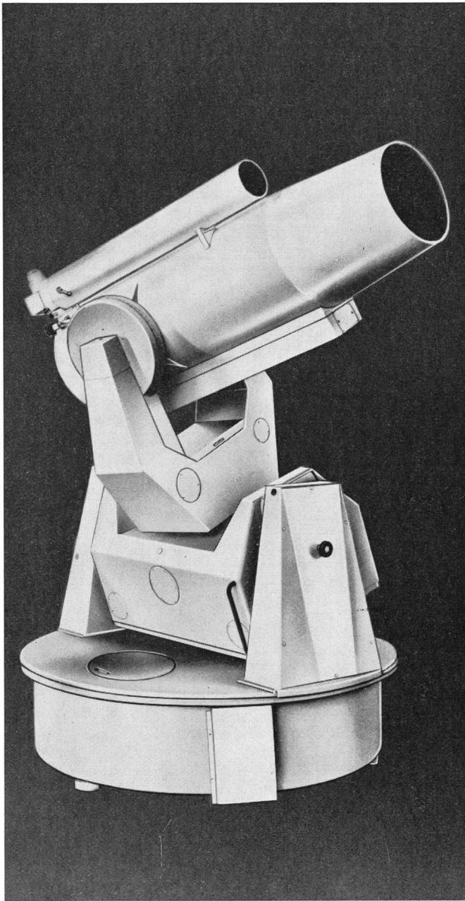
Das Gerät dient der genauen fotografischen Positionsbestimmung künstlicher und natürlicher Himmelskörper in bezug auf das Fixsternsystem. Es ist dazu mit folgender SCHMIDT-Optik ausgerüstet: Brennweite 780 mm, Durchmesser des Hauptspiegels 530 mm, Durchmesser der Korrekionsplatte 425 mm. Das geebnete Bildfeld hat einen Durchmesser von 155 mm.
