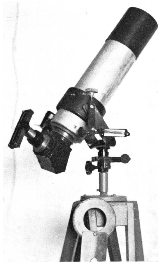
Abb. 3: Selbstbau-Fernrohr 80/500 mit Feinbewegungen in Azimut und Höhe mit Zenit-Penta-Prisma; auf dem Okular der beschriebene Sonnenkeil.
