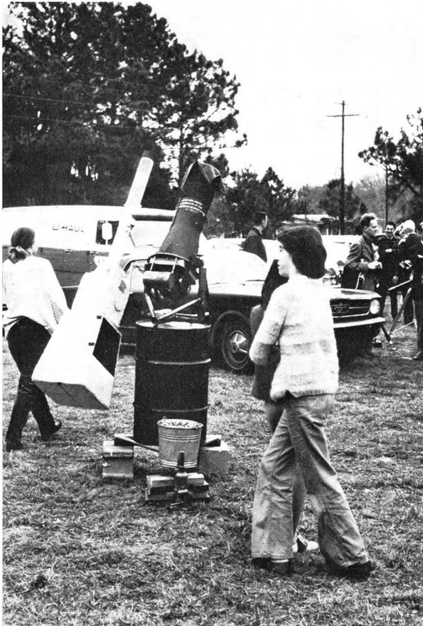
Fig. 1: Le pied est composé de briques et d'un tonneau de gouddron avec contrepoids formé d'un seau rempli de limaille de plomb.
