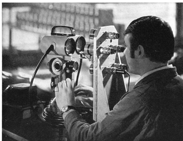
Bild 2: Justierung der mechanischen und optischen Elemente am Zielkopf des Infrarot-Distanzmessers Wild DI 10.
