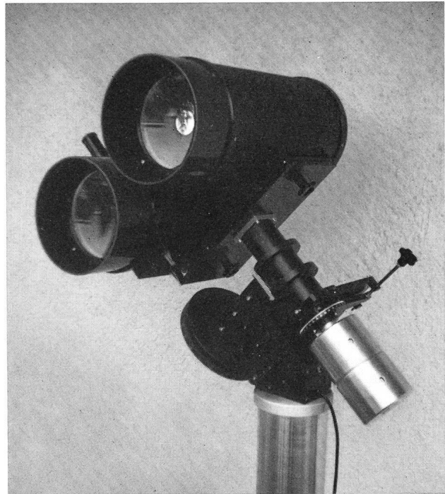
MAKSUTOW-Doppel-Teleskop 200/500 mm und 3200 mm
