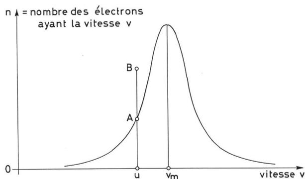
Fig. 2: Répartition statistique des électrons dans un gaz ionisé.
