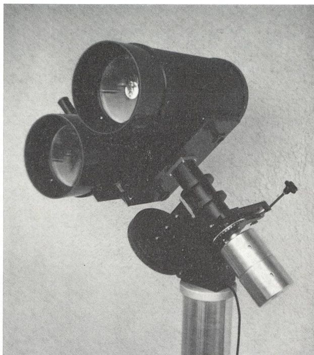
MAKSUTOW-Doppel-Teleskop 200/500 mm und 3200 mm
