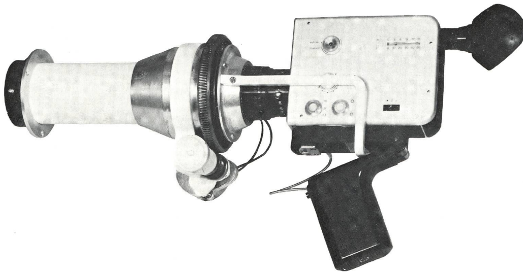
Abb. 6: Der Filmkameraansatz des Instruments von H. BRÄGGER.
