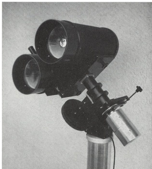
MAKSUTOW-Doppel-Teleskop 200/500 mm und 3200 mm
