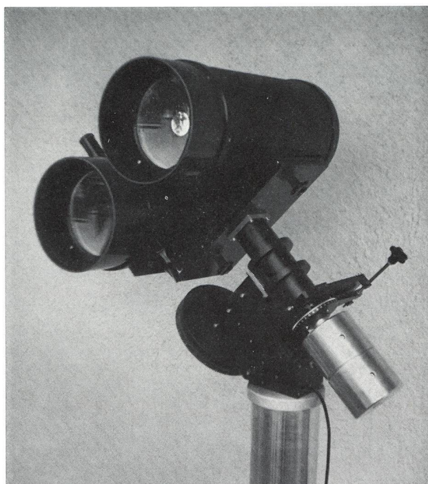
MAKSUTOW-Doppel-Teleskop 200/500 mm und 3200 mm
