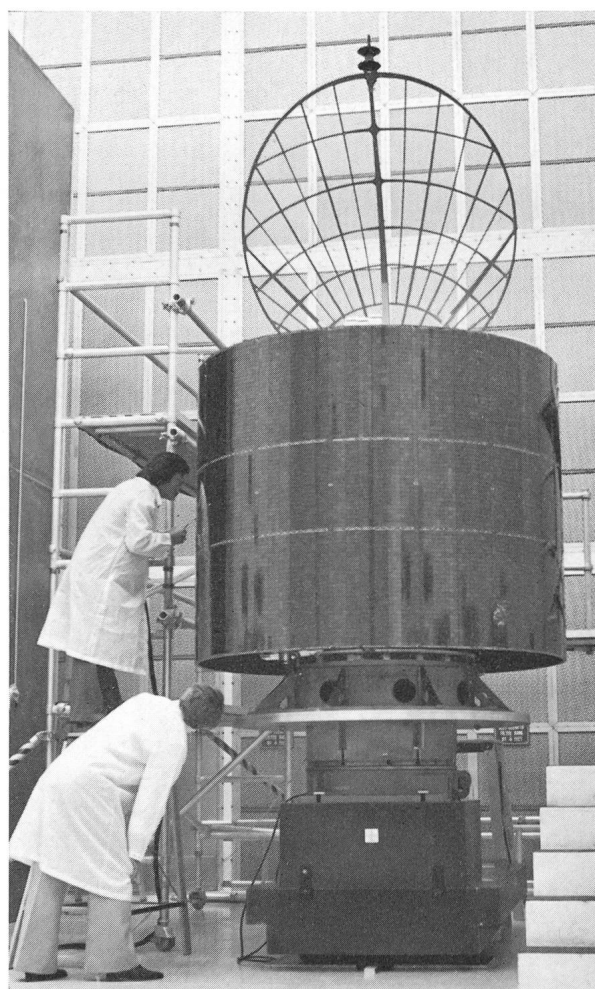
Abb. 1: Ein moderner Nachrichtensatellit (Telsat C) für die gleichzeitige Übertragung von 9600 Telephon- oder Radio-Sendungen oder 10 Farbfernsehsendungen. Er wurde im April 1975 mit einer Delta-Rakete auf eine synchrone Umlaufbahn in 36234 km Höhe gebracht und bedient von einer Position über Los Angeles aus das nördliche Canada und Alaska. NASA-Photo 75-HC-171.
