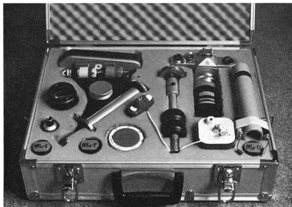
Bild 4: Das zerlegte und in ein Flugzeug-Suitcase verpackte Instrument. Ganz rechts: Das in den Bildern 1-3 nicht gezeigte Leitrohr.
