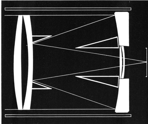
Besondere Vorteile: Baulänge nur  $\frac{1}{4}$  von der einer **Schmidt**-Kamera und nur  $\frac{1}{2}$  von der einer **Matsutov**-Kamera. Streng geebnetes Bildfeld, Fokus ausserhalb des Systems, Aufnahmen mit normalen Kameraansätzen (Anschluss vorgesehen)
