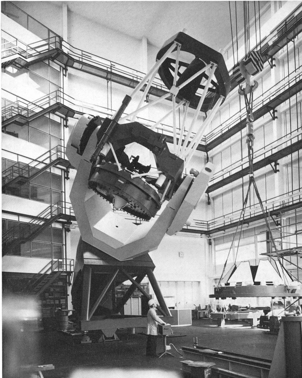
Abb. 6: Das 2,20 m-Zeiss-RC-Teleskop für *Calar Alto* beim Werksaufbau in der grossen Montagehalle von Carl Zeiss, Oberkochen. Deutlich ist die zusätzliche Verknotung im Gittertubus (vorne) zu sehen, die notwendig ist, um den neuartigen Strahlengang des COUDÉ-Lichtbündels zu ermöglichen. Werkphoto: Carl Zeiss, Oberkochen.
