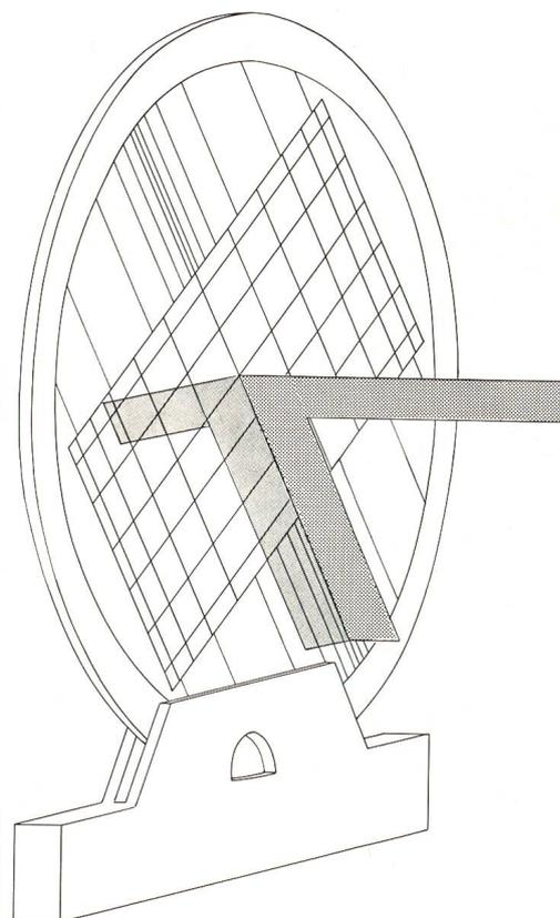
Fig. 8: Dessin d'un cadran-boussole, vue perspective montrant l'appareil sous la latitude de Paris (48° 50') le 21 janvier (ou novembre) à 2<sup>h</sup>45<sup>m</sup> de l'après-midi.
