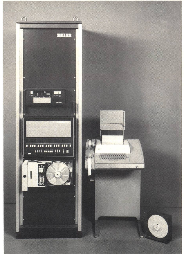
Fig. 3: Der Prozess-Rechner mit Teletype zur Steuerung des 2,20 m- Zeiss Teleskops. Der Rechner übernimmt auch die Antriebsbefehle für die Kuppel und den Windschirm.
