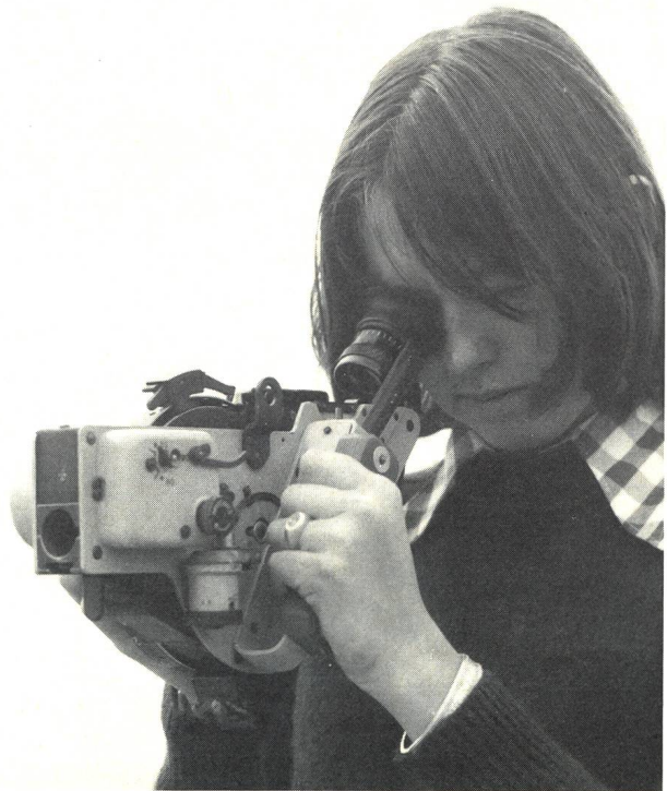
Fig. 1: Das Stern- oder Sonnenlicht fällt von links oben auf einen unter dem Okular befindlichen Spiegel, der mit Hilfe eines grossen, mit Teilung versehenen Drehknopfes bewegt werden kann. Der Spiegel ist halbdurchlässig und gestattet gleichzeitig den Blick auf die im vorderen Teil des Apparates befindliche Dosenlibelle.
