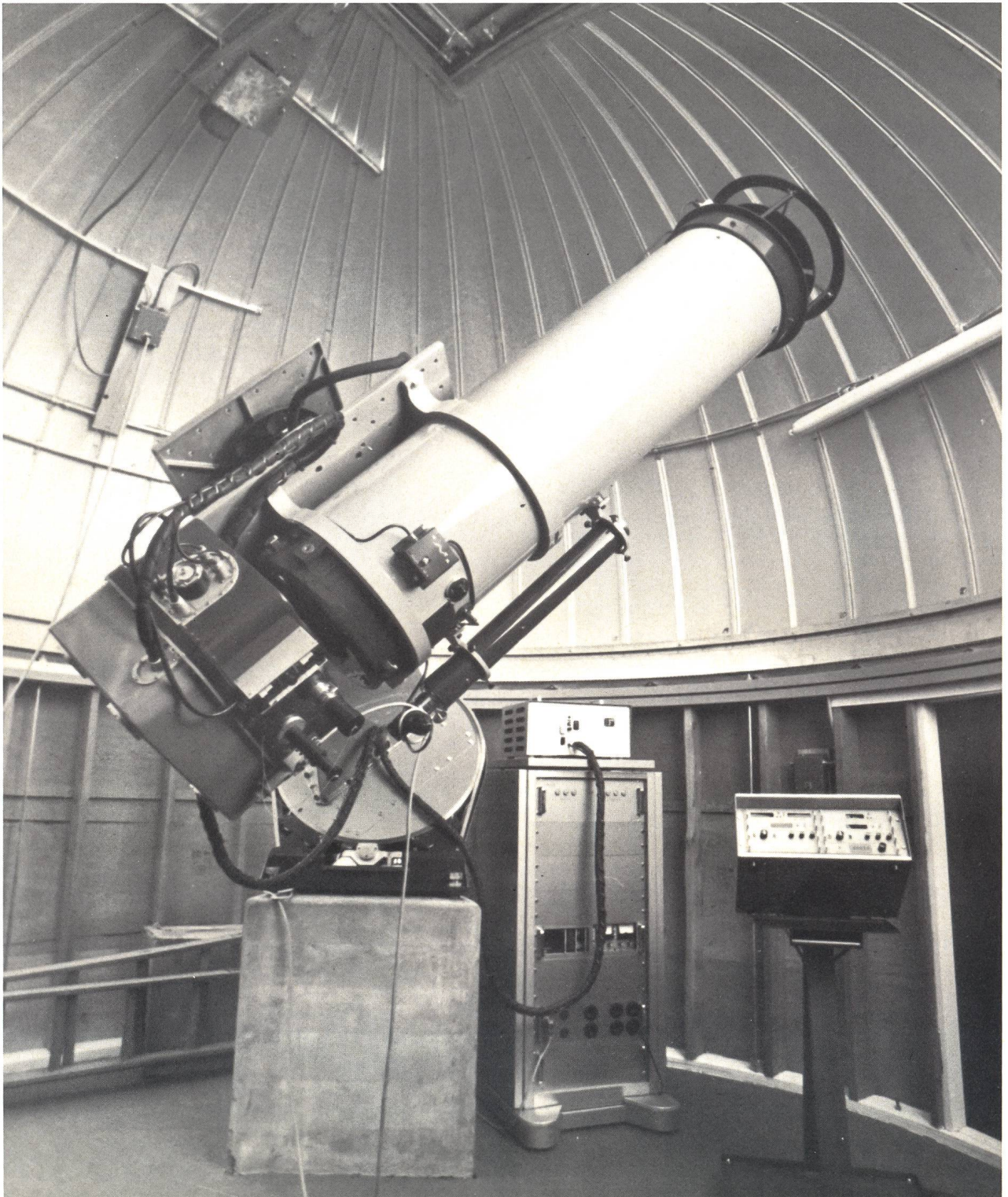
Fig. 4: Le télescope de 40 cm avec le photomètre photoélectrique destiné aux observations en sept couleurs UBVB 1 B 1 V 2 G de la photométrie de Genève. A droite la console de commande où s'affichent les coordonnées \alpha et \delta de l'objet visé.
