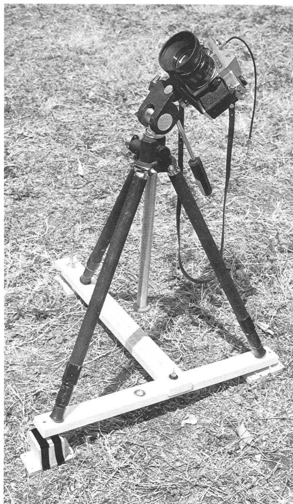
Fig. 3: So wurde der Latten-Unterbau im Mombasa verwendet. Beim südlichen Ende (links) die Holzunterlagen (entsprechend 4° südl. Breite), beim westlichen Ende (hinten) die Nachführschraube.
