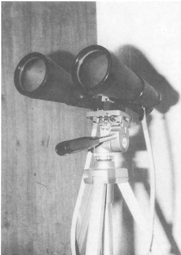
Abb. 1: Der Feldstecher als Beobachtungsinstrument (20 x 70 mm)
