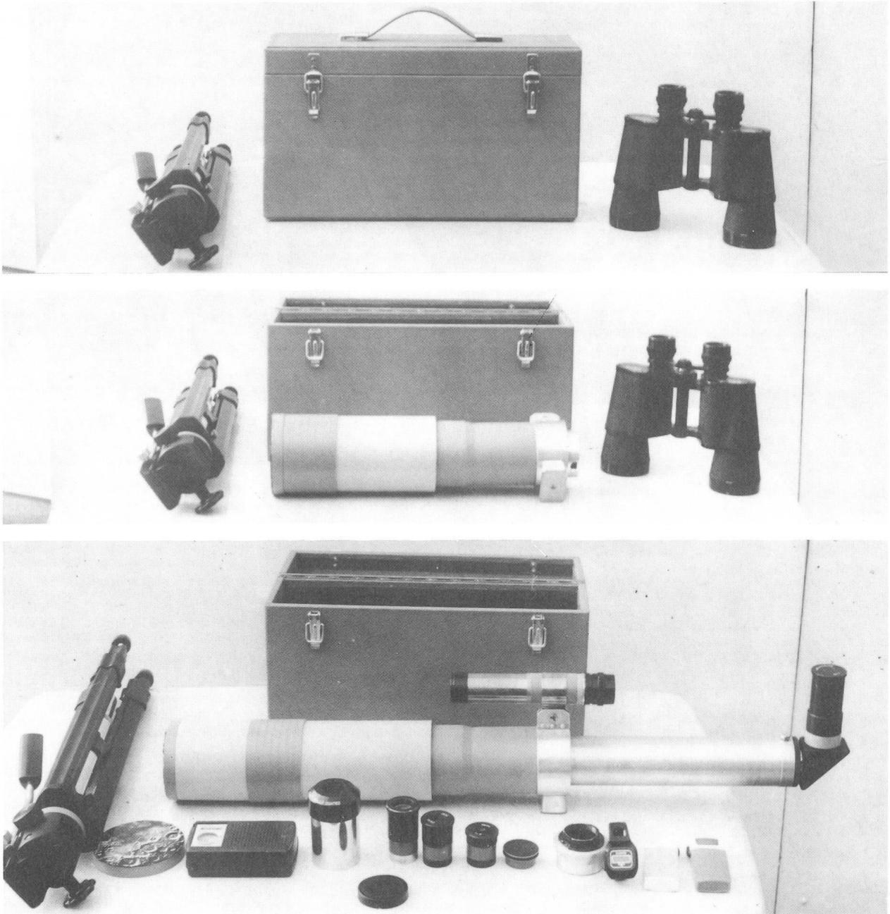
Das Teleskop für die Flugreise mit 80 mm Objektivdurchmesser ist zusammen mit dem Zubehör in einem kleinen Koffer untergebracht. Der Feldstecher dient zum Grössenvergleich.
