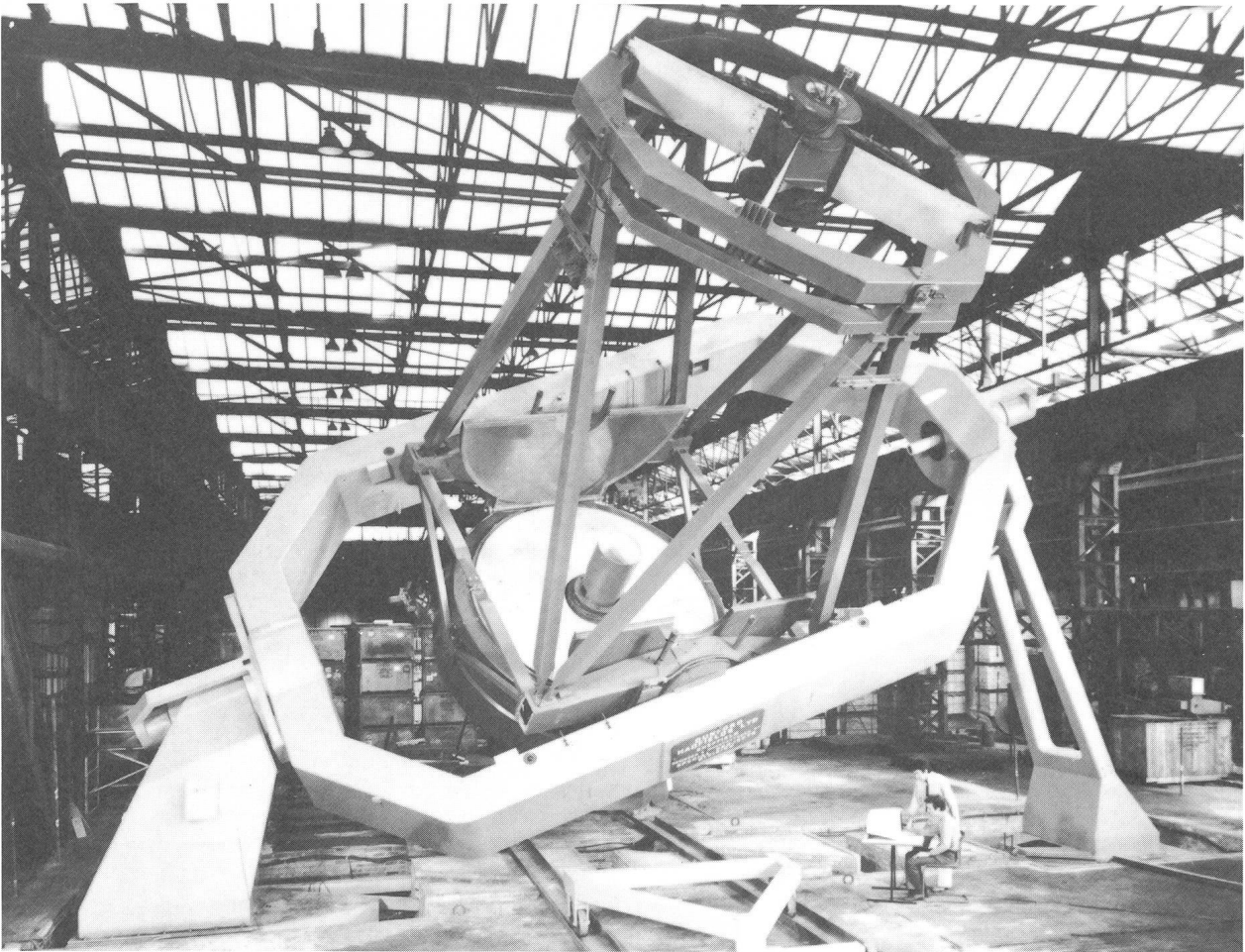
Blick auf das in Grossbritannien im Bau befindliche Infrarot-Teleskop, das im Lauf des Jahres 1978 auf dem über 4000 m hohen Gipfel des erloschenen Vulkans Mauna Kea in Hawaii in Betrieb genommen wird. (BFF)
