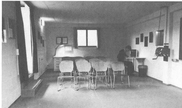
Blick in den Vorraum, der unter anderem für Dia-Vorfürungen und Kurzvorträge eingerichtet ist. Mit dem rechts erkennbaren Schneckengetriebe lässt sich das etwa vier Tonnen schwere Giebeldach leicht von Hand öffnen.
