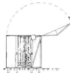
Wände, Türe und Dach in Stahlblech hellgrün/beige einbrennlackiert, Boden in Holz, Dach umklappbar zum Öffnen und Schliessen von Hand, verriegelbar. Einschliesslich separat fundiertes Stahlrohr für Instrumente. Abmessungen: Breite 1,8 m, Länge 2,3 m und Höhe 1,95 m.
