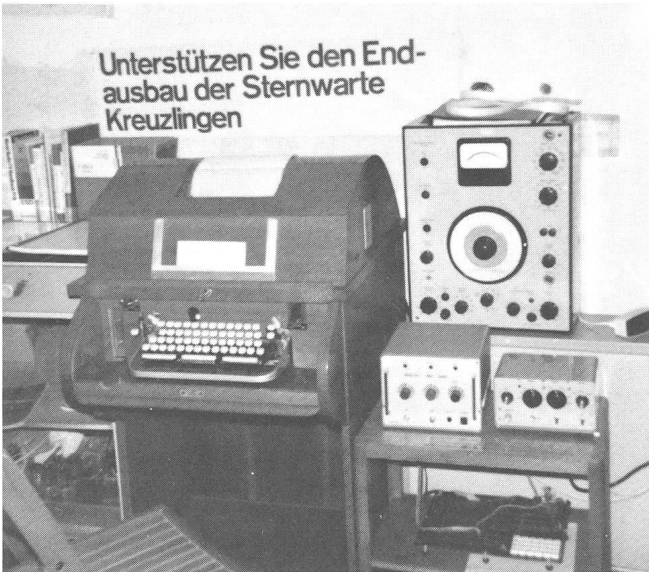
Abb. 5: Digitale Ausgabeinheit bestehend aus: Fernschreiber LORENZ 15, Analog/Digital — Wandler, Fernschreibkonverter, Mikroprozessorplatte INTEL 8085. Rechts aussen Präzisions-NF-Generator.
