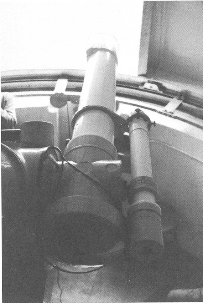
Abb. 3: 15 cm-Coudé-Refraktor der Firma Zeiss. Rechts das Sonnenleitrohr.
