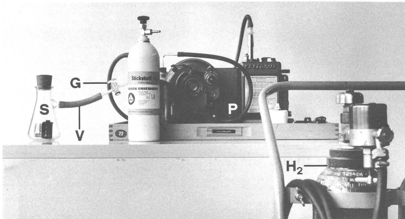
Die zum Hypersensibilisieren von Filmen benötigte Einrichtung. G: Glashahn, H<sub>2</sub>: Wasserstoff-Flasche, P: Vakuumpumpe, S: Saugflasche, V: Vakuumschlauch. Für die Filmbehandlung mit «Forming Gas» wird noch Stickstoff gebraucht. Steht keine grosse Stahlflasche zur Verfügung, so sind im Handel auch kleine Druckgasflaschen erhältlich. Die hier abgebildete N<sub>2</sub>-Flasche liefert Kümmerly und Frey, Bern.
